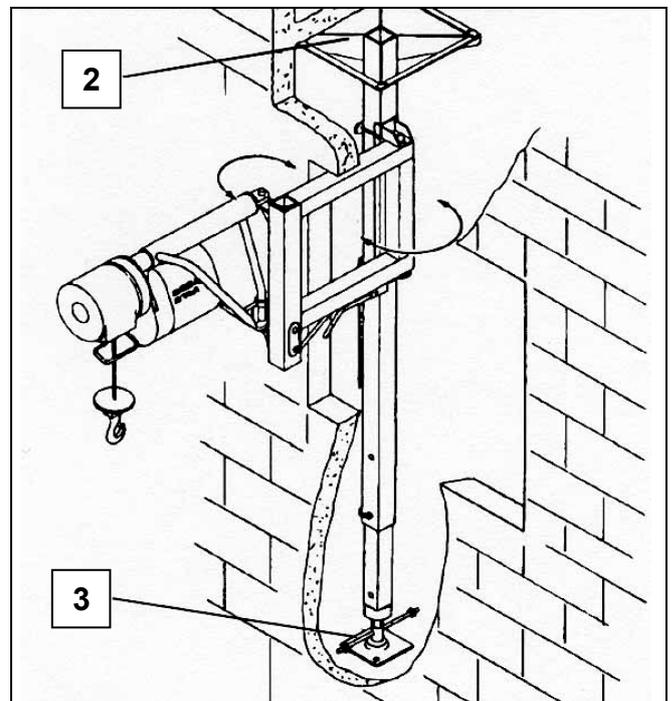
Fig. 13 Geschossstütze montieren
