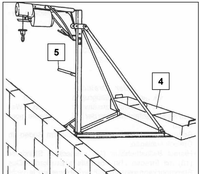
Fig. 9 Dreibock positionieren
