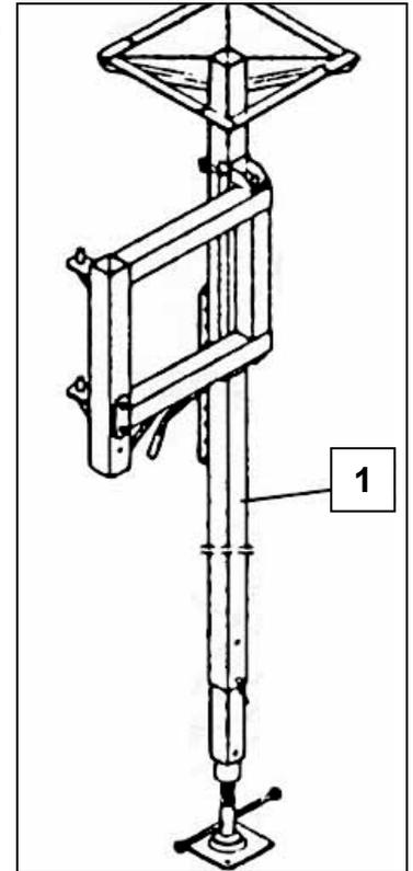
Fig. 12 Geschossstütze
