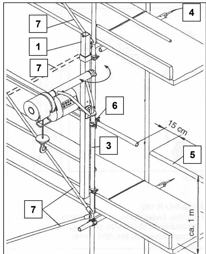
Fig. 11 Gerüstbefestigung montieren
