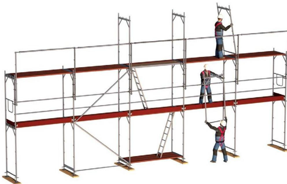
Bild 30: Montage der Gerüstlage im Schutze des MSG.
