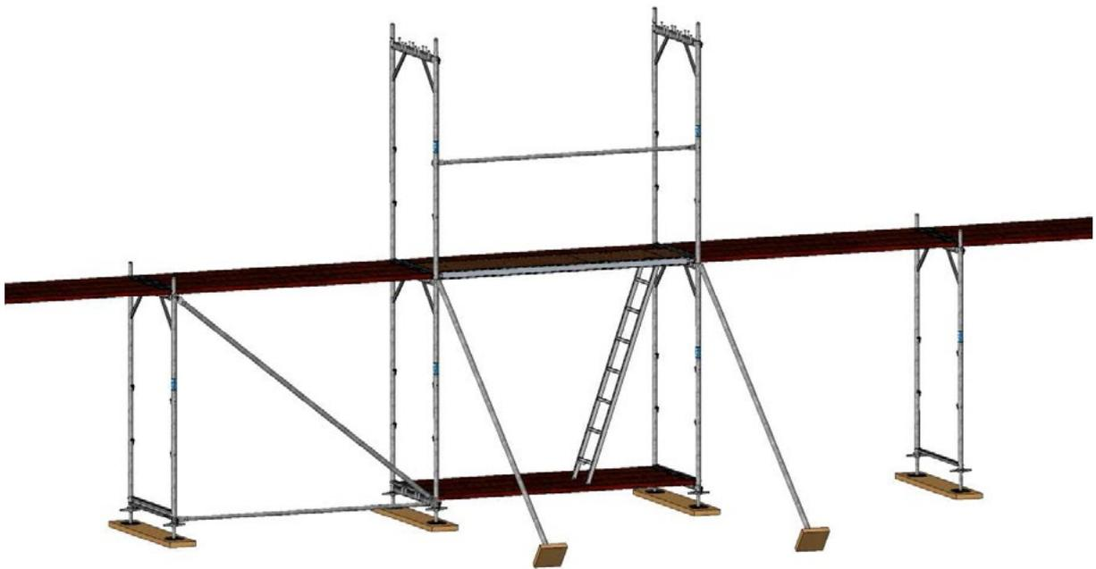
Bild 20: Beispiel für eine vorübergehende Kippsicherung der ersten Gerüstlage.
