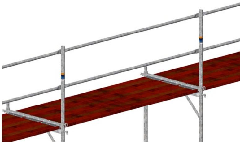
Bild 45: Oberer Abschluss mit Geländerpfosten und Belagsicherungen.
