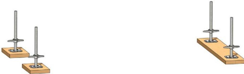
Bild 1: Lastverteilernder Unterbau mit Gerüstbohlen
