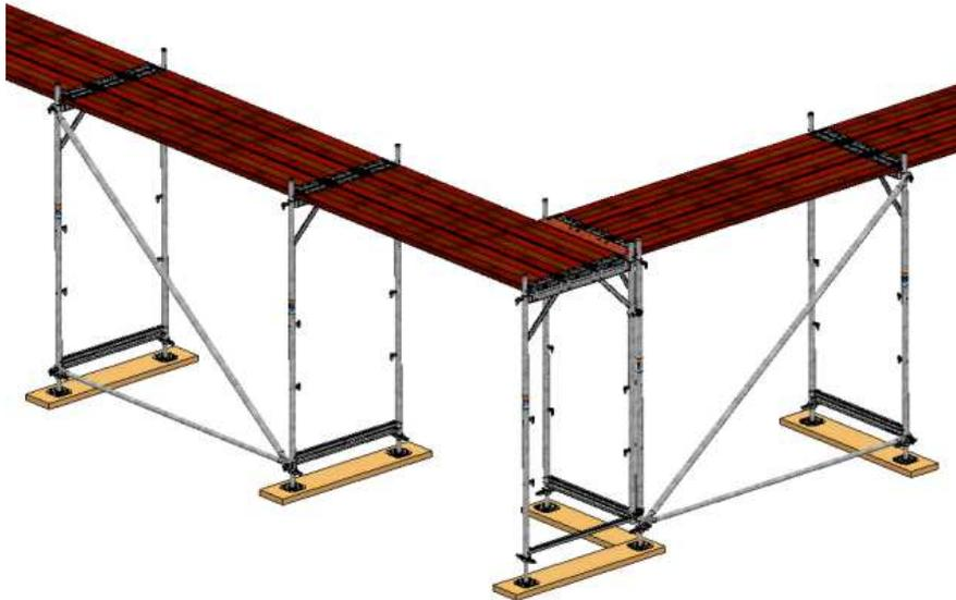
Bild 18: Eckausbildung mit zwei Vertikalrahmen
