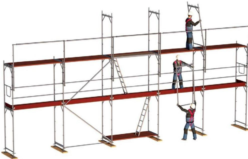
Bild 25: Beispiel für den Vertikaltransport von Hand.
