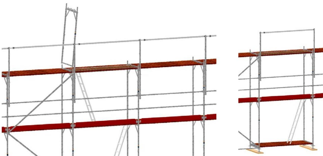
Bild 31: Aufstecken eines Vertikalrahmens.
