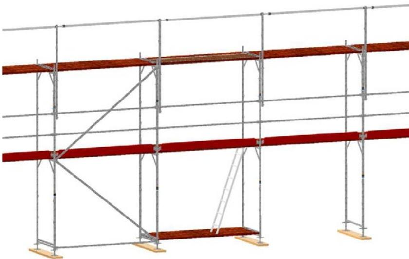
Bild 29: Montage der weiteren MSG- Einheiten
