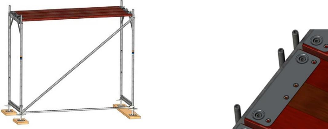
Bild 15: Systembeläge in die Zapfen eingehängt
