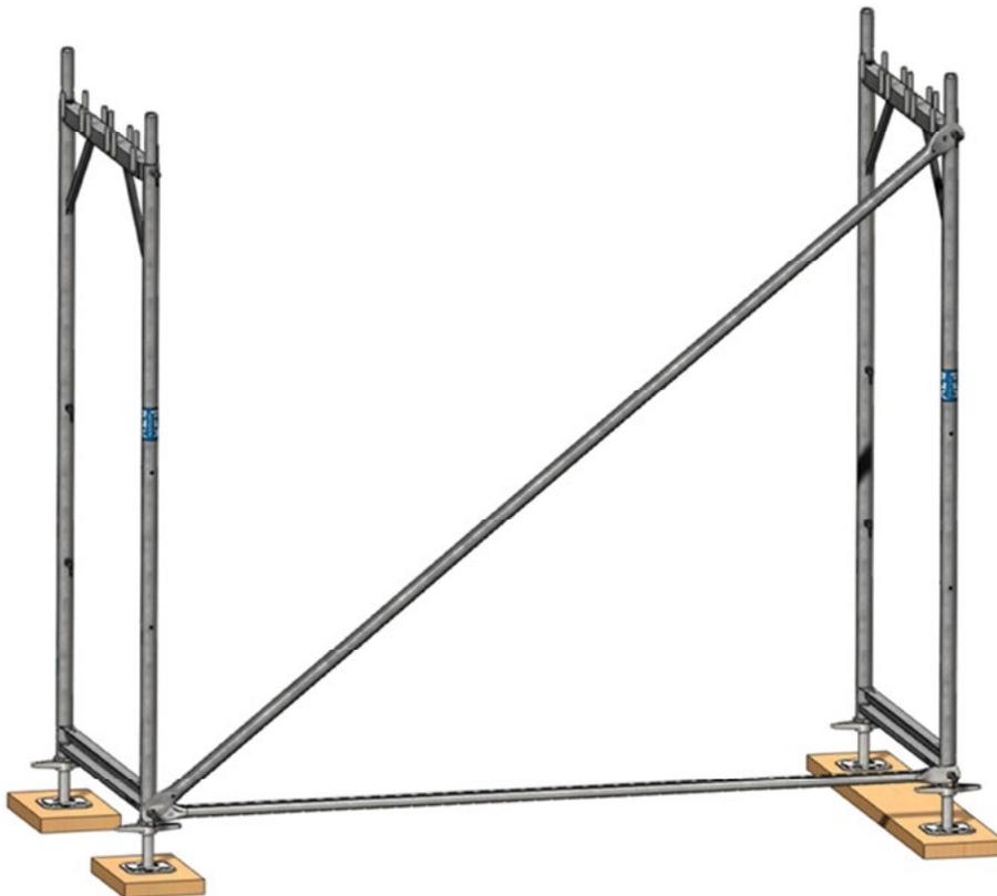
Bild 13: Aufbau des ersten Gerüstfeldes: Vertikaldiagonale
