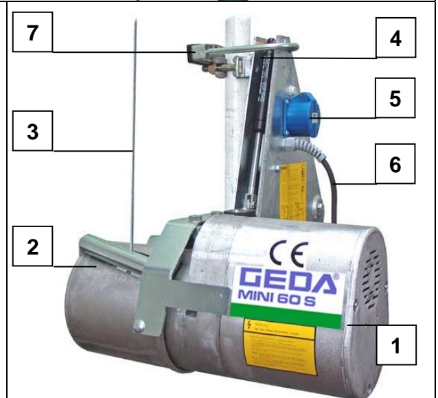
Fig. 5 Bauteile GEDA MINI 60 S
