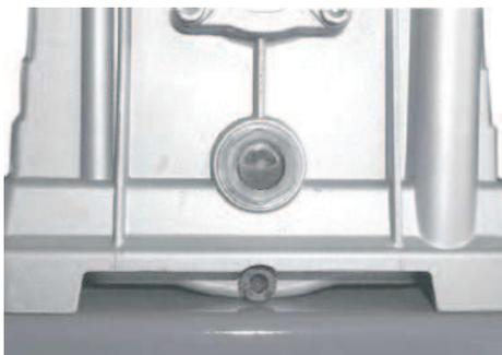
**verschlissenes Öl kann über die Ablassschraube abgelassen werden**
