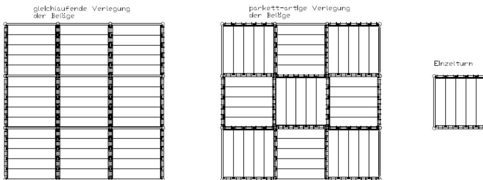
a. Verlegrichtung der Beläge: gleichlaufend in Raumgerüsten
