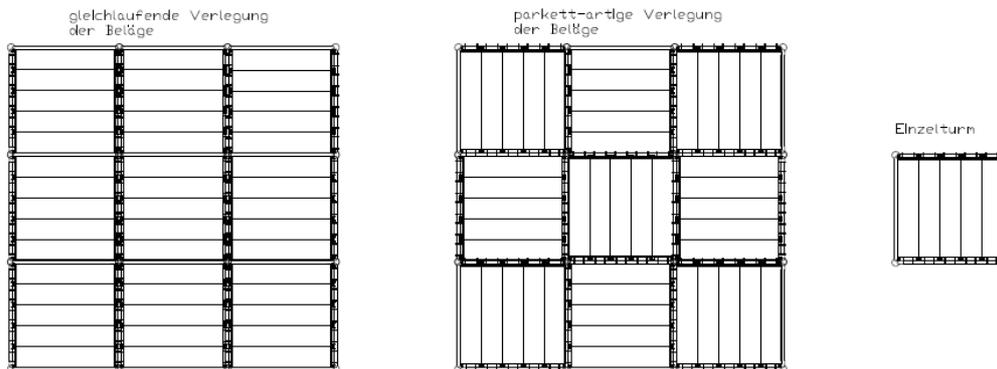
a. Verlegrichtung der Beläge: gleichlaufend in Raumgerüsten
