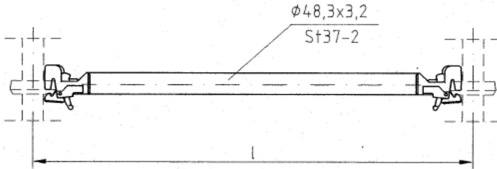
Gerüstklasse in Abhängigkeit von der Stützweite der Riegel, der Feldlängen und der Verlegrichtung der Beläge:
