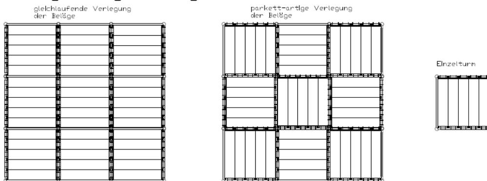
a. Verlegrichtung der Beläge: gleichlaufend in Raumgerüsten
