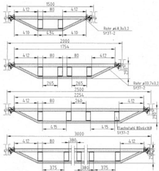
Gerüstklasse in Abhängigkeit von der Stützweite der Riegel, der Feldlängen und der Verlegrichtung der Beläge:
