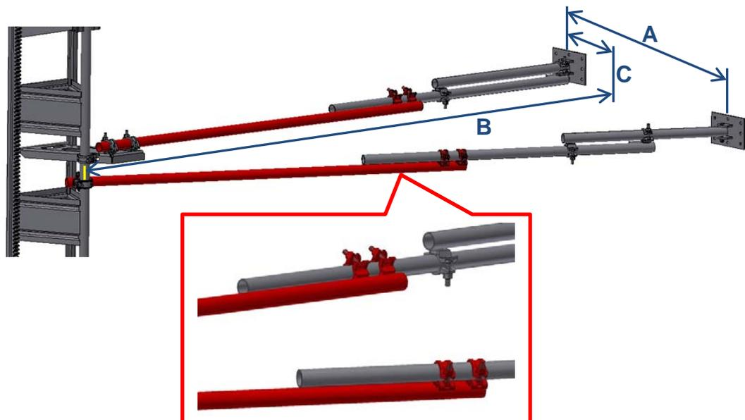
Anzugsmoment der 1 ½"- Rohrschellen = 50 Nm / Schlüsselweite (SW) 22 mm
