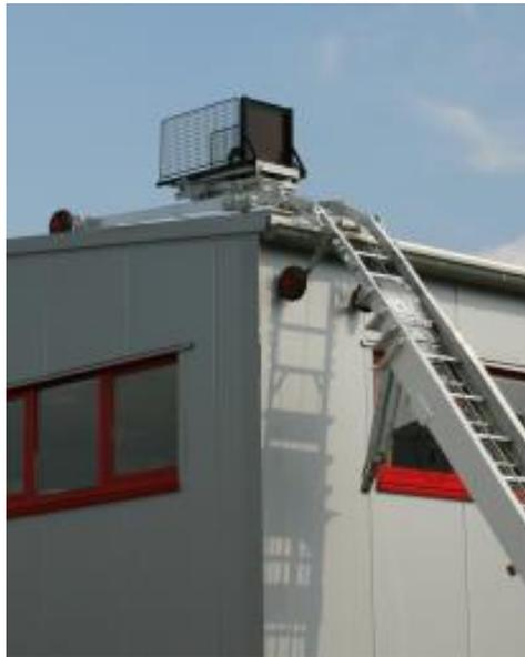
Abb. 6-56 Toplight 21 mit Knickstück und Schienenverlängerung
