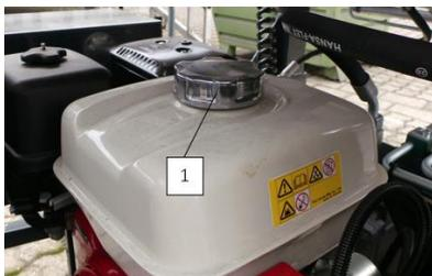
Abb. 6-22 Tankverschluss
