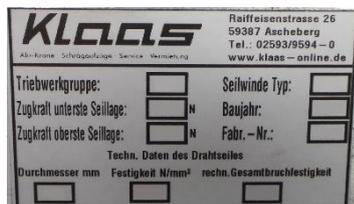
Abb. 3-4 Typenschild Schlittenwinde
