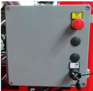
Abb. 2-5 Hauptsteuerungseinheit
