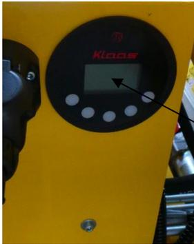
Die Fehlercodes werden Ihnen bei jeder Störung des Schrägaufzugs im Display des Schaltkastens angezeigt. Um die vorliegende Störung zu beseitigen, sprechen Sie bitte mit dem Kundendienst.
