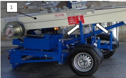
Das Schienenpaket (1) muss vollständig in der Auflage (Pfeile) liegen.
